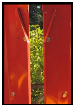
Ліфтера з механізмом регулювання зазору.
