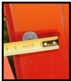
Ліфтера з механізмом регулювання зазору.
